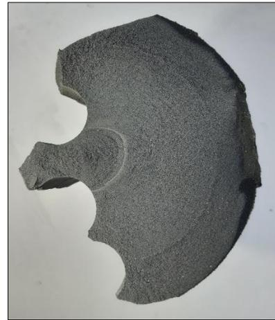
Abb. 2: Bruchfläche einer Verfüllsäule
